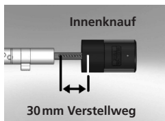
Schematische Darstellung Innenknopf-Verstellung
